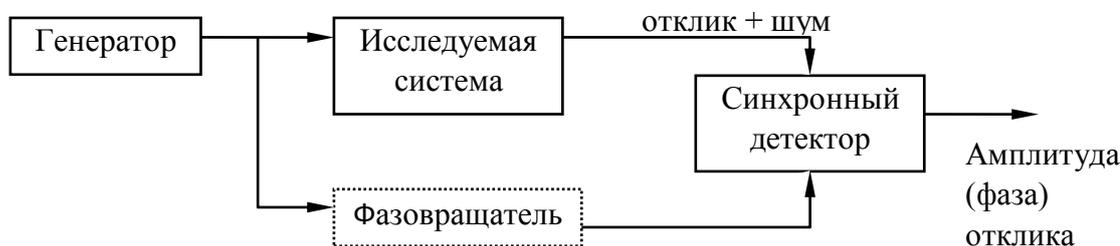
Рисунок 2 – Схема регистрации слабого сигнала
