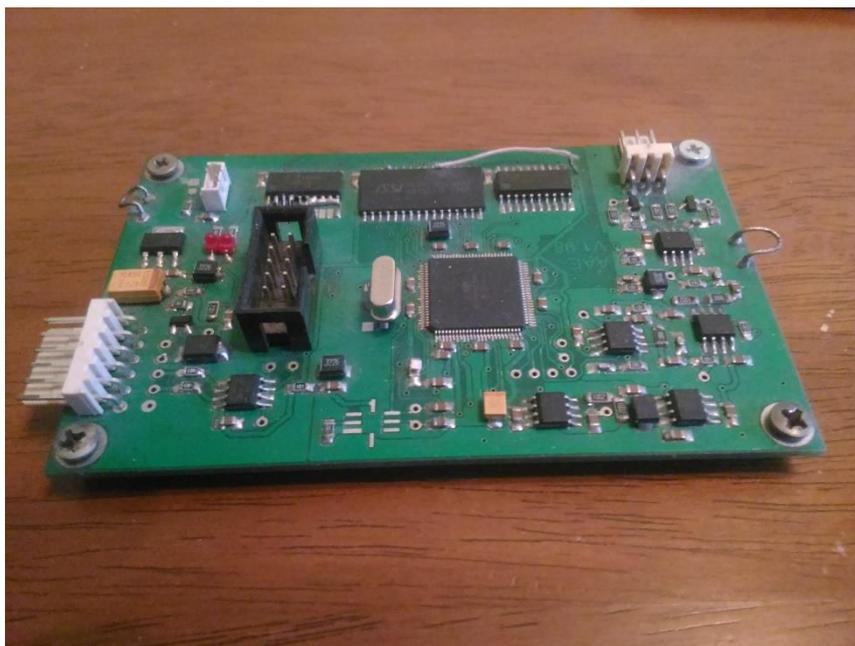
Рисунок 19 – Устройство мониторинга зданий методом акустической эмиссии
