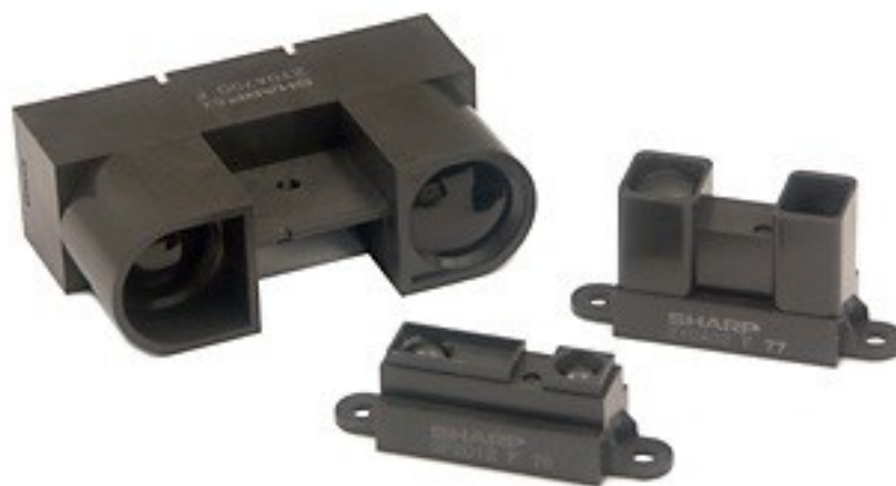
Рисунок 2.22 - Внешний вид инфракрасного датчика-дальномера Sharp 0A700
