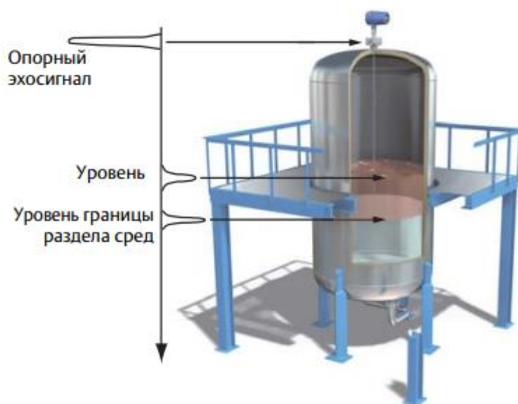
Рисунок 13 – Иллюстрация принципа действия датчика
