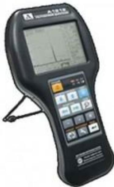
Рисунок - 3. Ультразвуковой дефектоскоп А1212 МАСТЕР.
