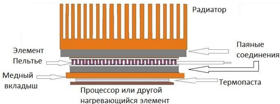
Рисунок - 8. Типовая конструкция кулера на ТЭМ.
