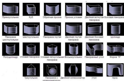
Рисунок 19. Разновидности форм резервуара
