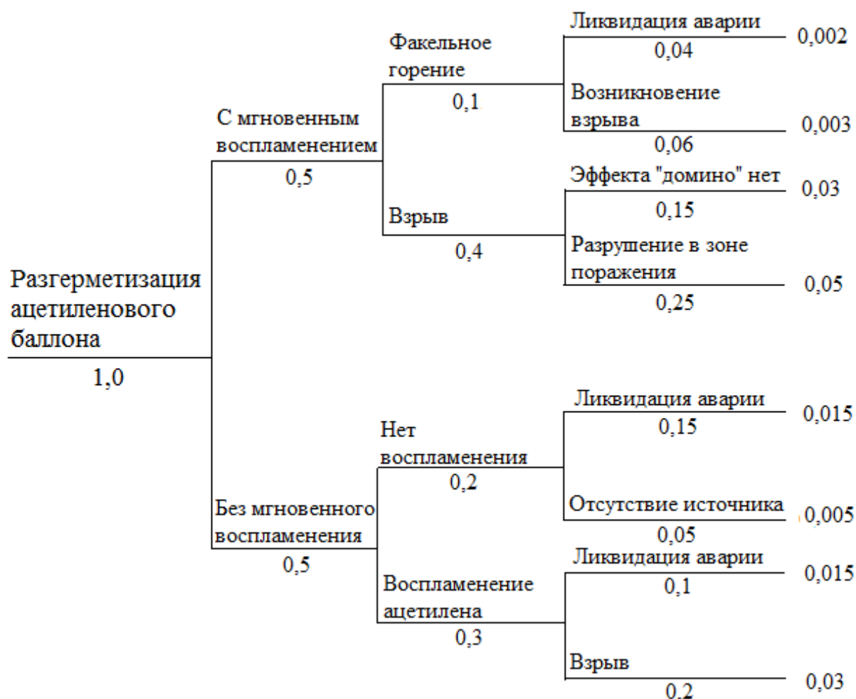
Рисунок 3.3 – «Дерево событий» аварии при разгерметизации ацетиленового баллона
