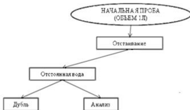
Рисунок 11 Схема обработки и анализа проб подземной воды
