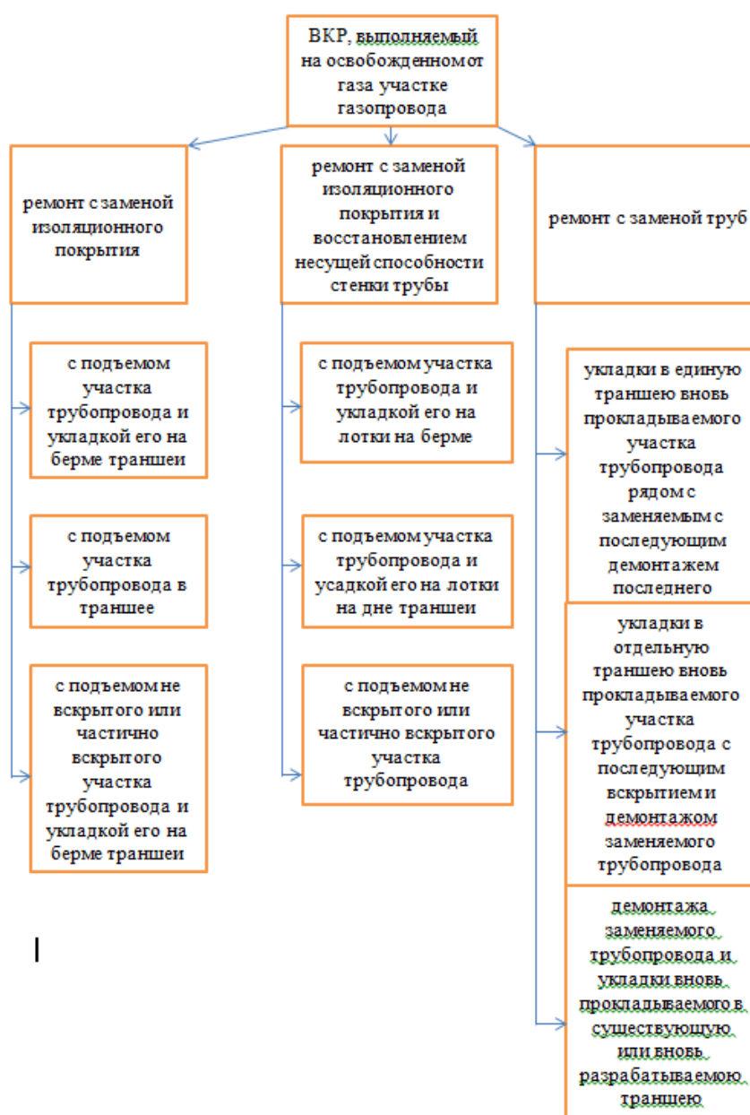
Рисунок 3.7 - Схема ВКР, на освобожденном от газа участке
