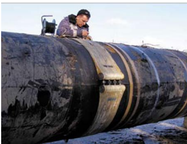
Рисунок 3.18 - Испытания трубы диаметром 1220 мм с муфтами РСМ-1220
