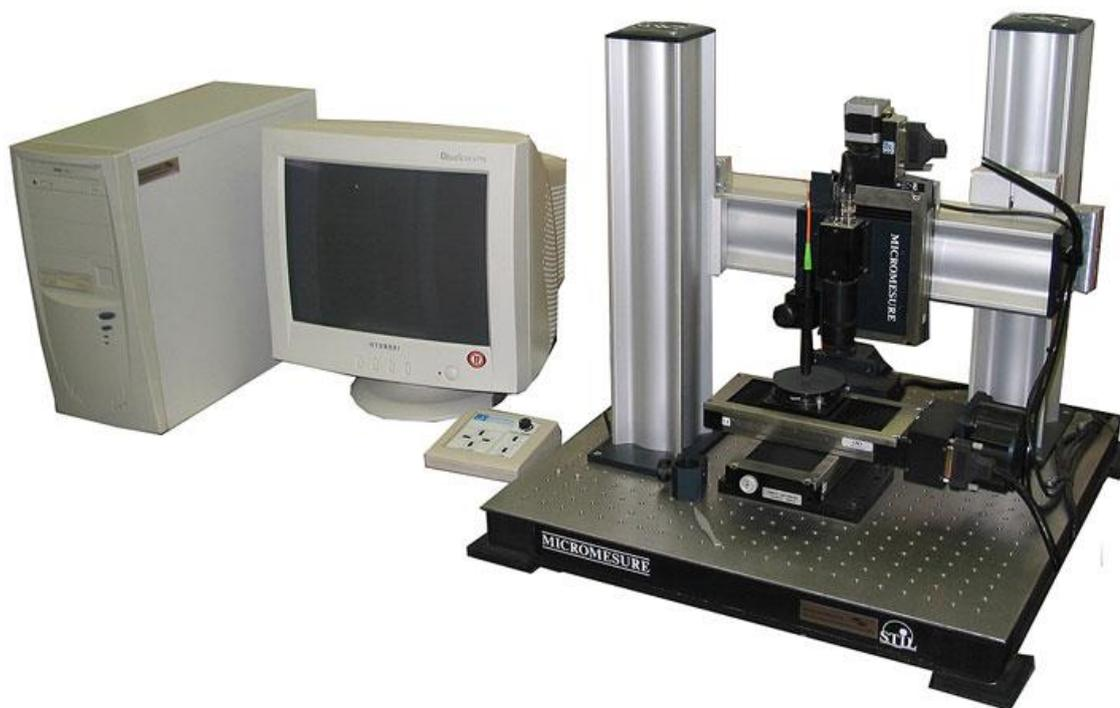
Рисунок 2.3 – Измерительная установка «Micro Measure 3D station»
