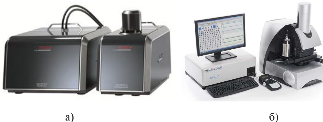
Рисунок 3.2.1 – Приборы для определения гранулометрического состава проб: а) лазерный анализатор частиц Fritsch Analysette Nanotec 22 plus, б) анализатор размера и формы частиц Malvern Morphologi G3-ID
