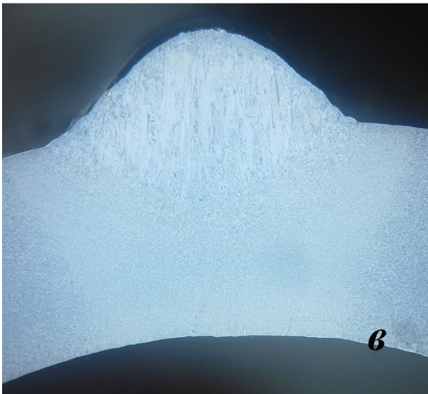
Рисунок 17. Проплавление при токе в 100 А: а) постоянный ток прямой полярности; б) постоянный ток обратной полярности; в) переменный прямоугольный ток; г) переменный синусоидальный ток.
