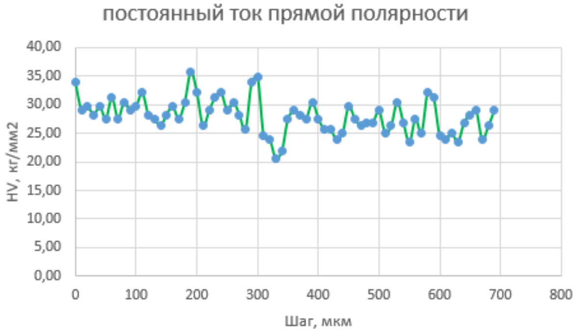
Рисунок 26. Микротвердость наплавленного металла при постоянном токе прямой полярности.
