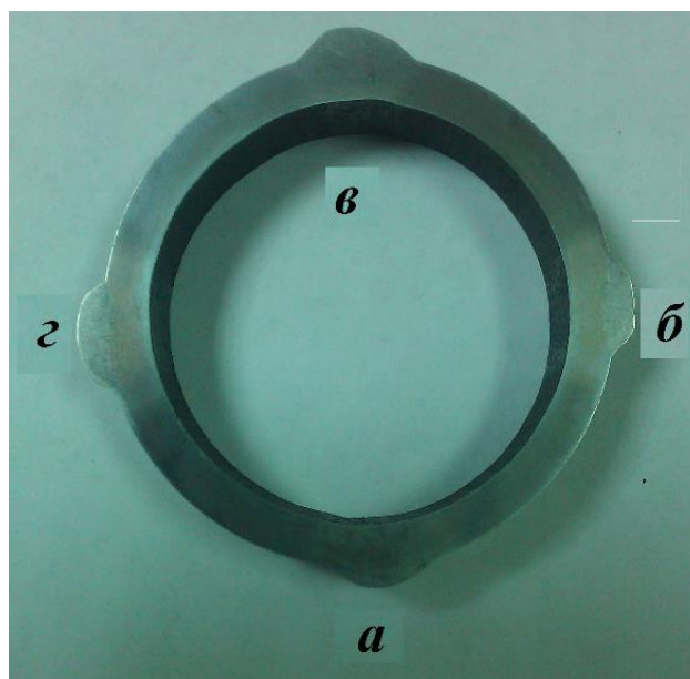
Рисунок 12. Исходный образец после шлифовки, полировки и травления: а – постоянный ток обратной полярности; б – постоянный ток прямой полярности; в – переменный прямоугольный ток; г – переменный синусоидальный ток.
