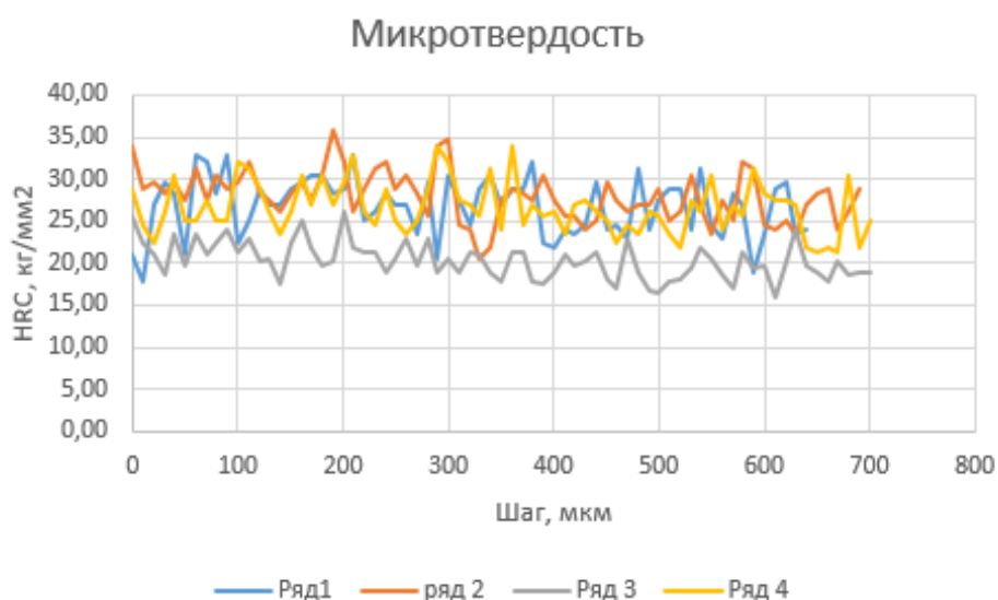
Рисунок 14. Микротвердость наплавленных образцов, где: ряд 1 – при постоянном токе обратной полярности; ряд 2 – при постоянном токе прямой полярности; ряд 3 – при переменном прямоугольном токе; ряд 4 – при переменном синусоидальном токе.
