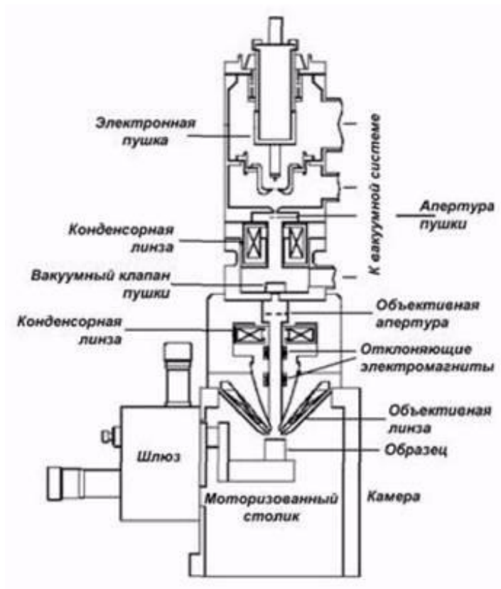
Рисунок 2.2 – Схема устройства современного растрового электронного микроскопа (РЭМ)
