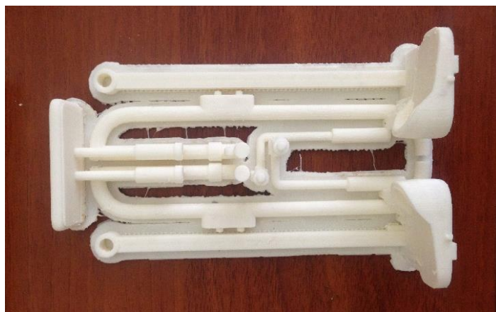
Рисунок 24. Напечатанные детали тренажера
