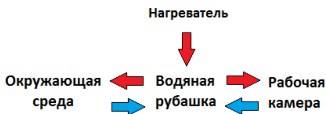
Рис. 12. Обмен энергией в химическом реакторе
