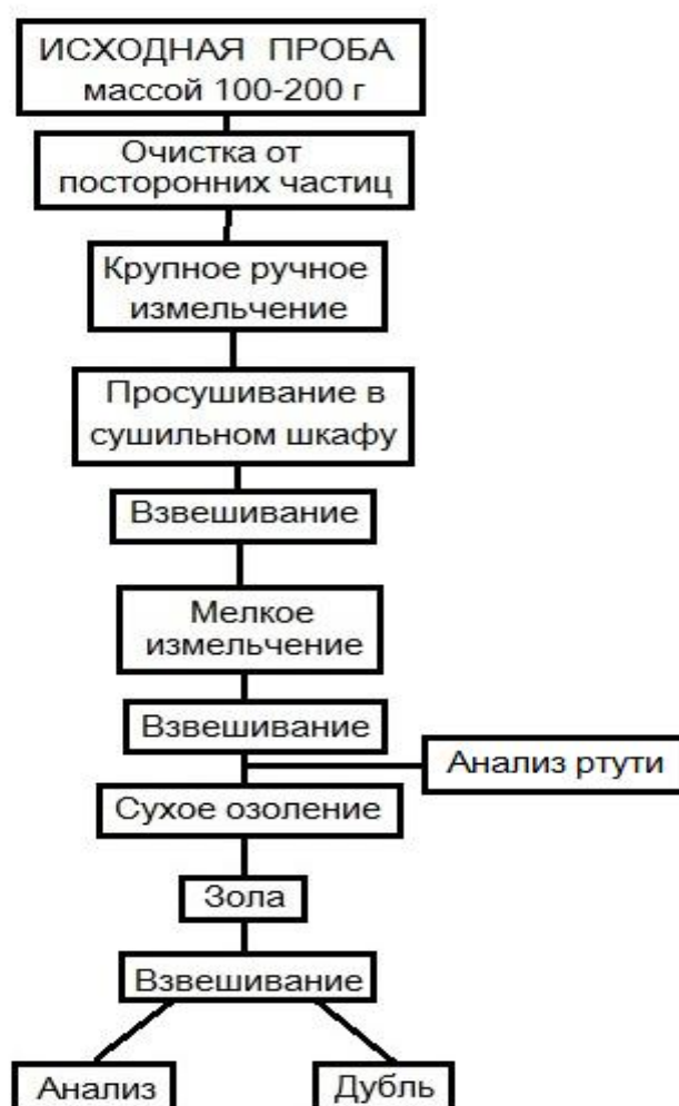
Рисунок 6.3 - Схема обработки и изучения проб растительности
