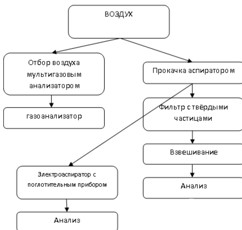
Рисунок 6.1- Схема обработки проб атмосферного воздуха
