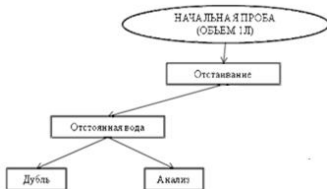
Рисунок 6.5- Схема обработки и анализа проб подземной воды
