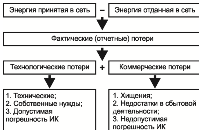
Рисунок 1.1. – Структура потерь электроэнергии на стадиях передачи и распределения
