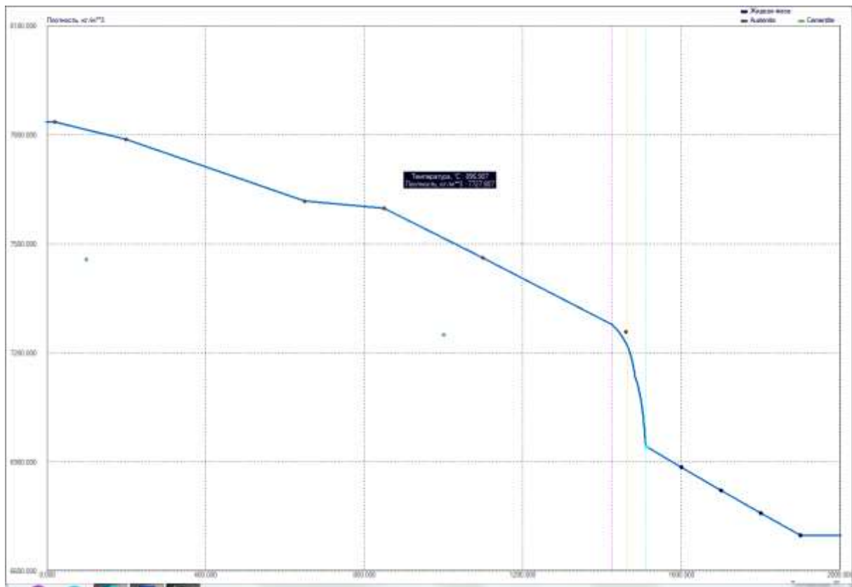
Рис. 14. Зависимость плотности для сплава SS1505 от температуры
