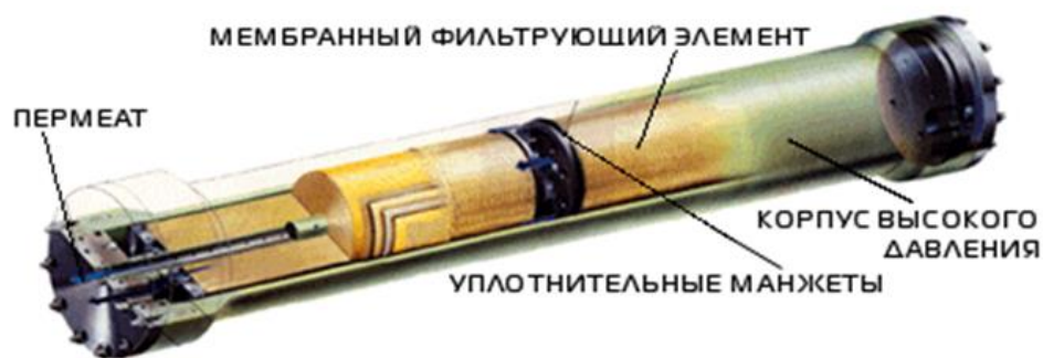
Рисунок 1.2.2.4 - Мембранный фильтрующий элемент
