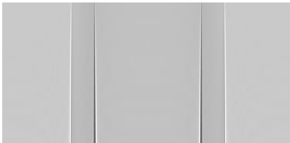
Рисунок 4.8 – Смоделированное с использованием волновой оптики распределение интенсивности для стеклянного капилляра при последовательно увеличивающемся расстоянии объект-детектор от 80 мм до 800 мм.
