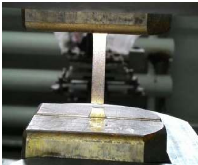
Рисунок 5 - Разрушенный образец из стали 30ХГСН2А в зажимах
