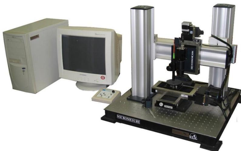
Рисунок 18 – 3D профилометр «Micro measure 3D station»
