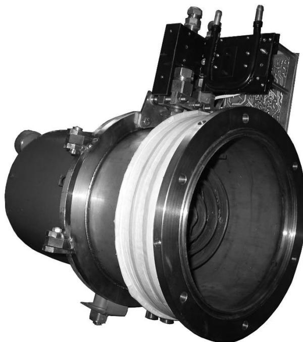
Рисунок 8 – Плазменный фильтр жалюзийного типа
