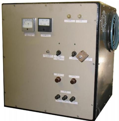
Рисунок 12 – Внешний вид генератора напряжения смещения
