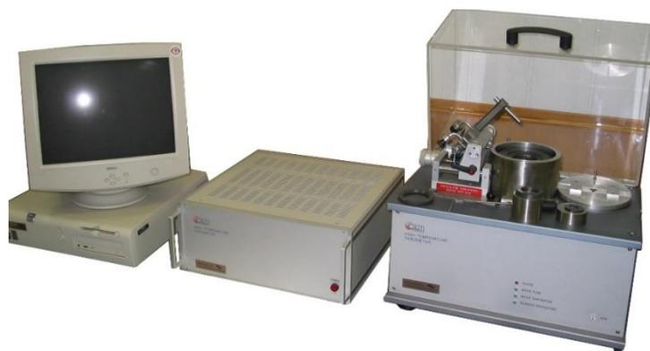
Рисунок 19 – Трибологическая установка ТНТ-S-AX-0000
