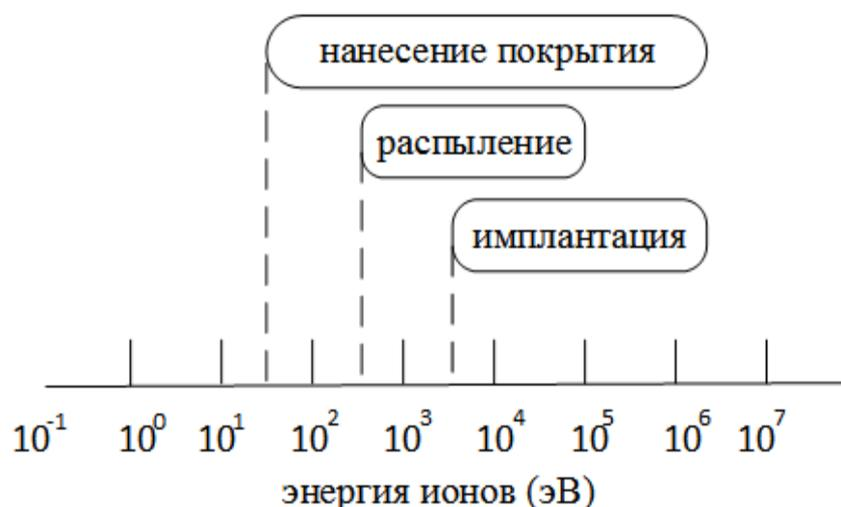
Рисунок 1 – Зависимость режимов обработки материала от энергии ионов
