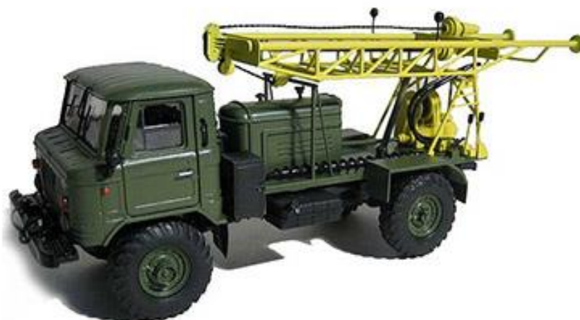
Рисунок 3.3 Буровая установка УГБ-1ВСГ [67]
