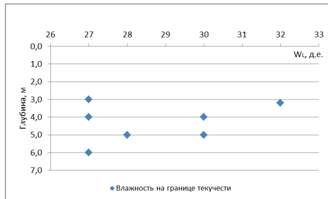
Рисунок 2.2 График изменчивости влажности на границе текучести по глубине
