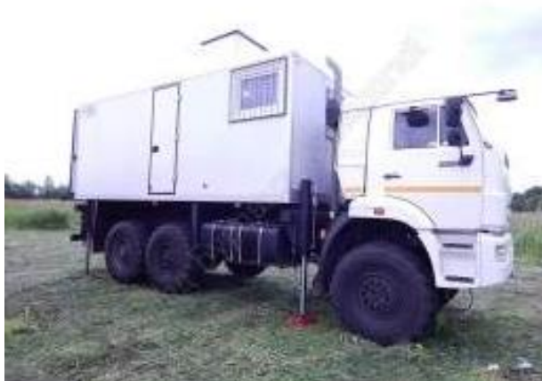
Рисунок 3.4 Установка статического зондирования УСЗ-15.ZBT на базе шасси КАМАЗ 43118 [64]
