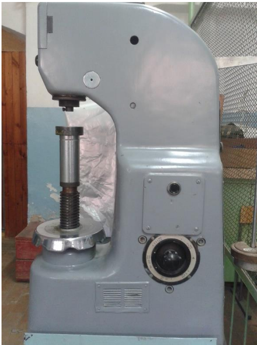
Рисунок 6 – Измерение твердости по Бринеллю: а) твердомер Бринелль б) схема измерения отпечатка твердости по Бринеллю (Р – нагрузка)
