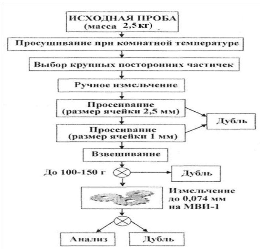
Рисунок 18 - Схема обработки анализа проб почв [31]
