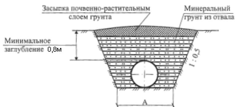
Рис. 3.3- Параметры траншеи на необводненном участке.
