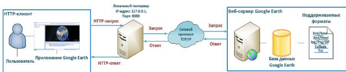
Рисунок 4.3.1 – Схема взаимодействия ИС с веб-сервером Google Earth
