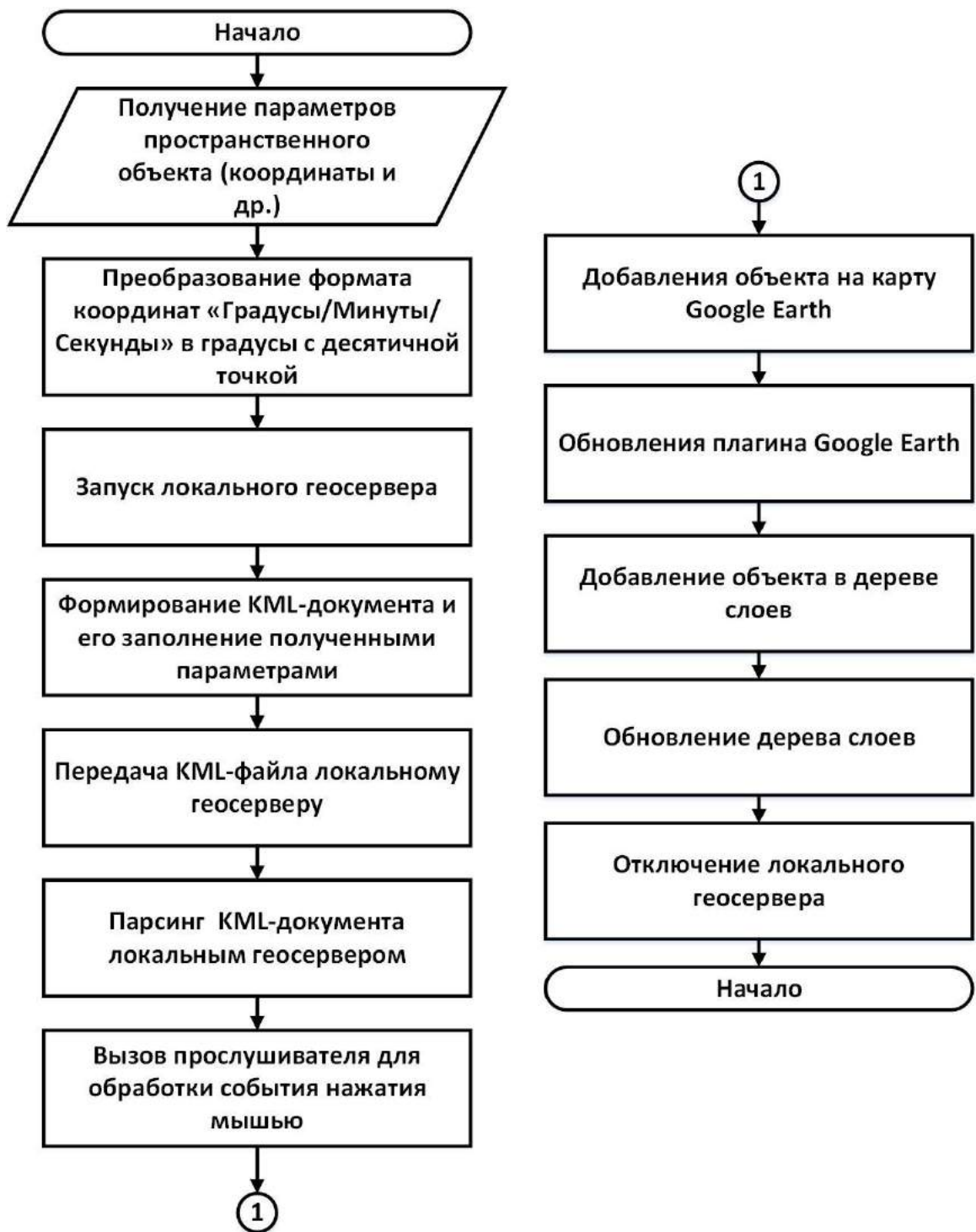
Рисунок Ж.4 – Алгоритм создания временных объектов на карте
