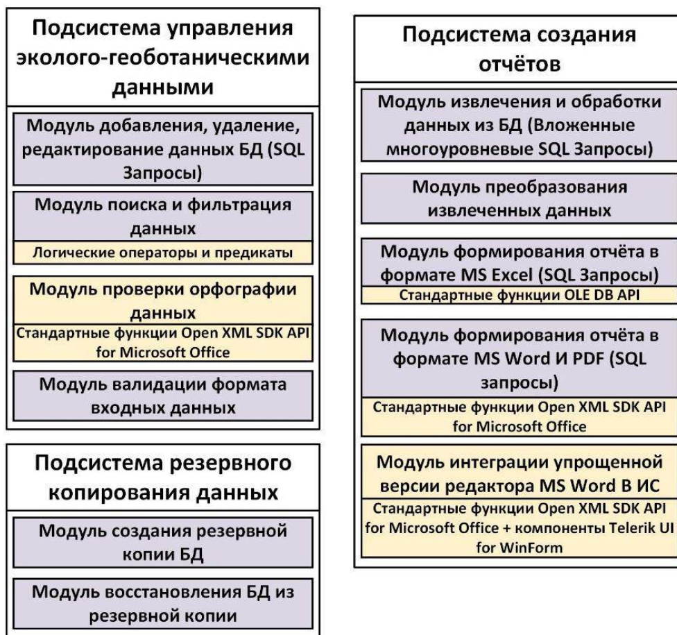
Рисунок 4.2.4 – Детализированная архитектура подсистемы создания отчётов, управления и резервного копирования данных
