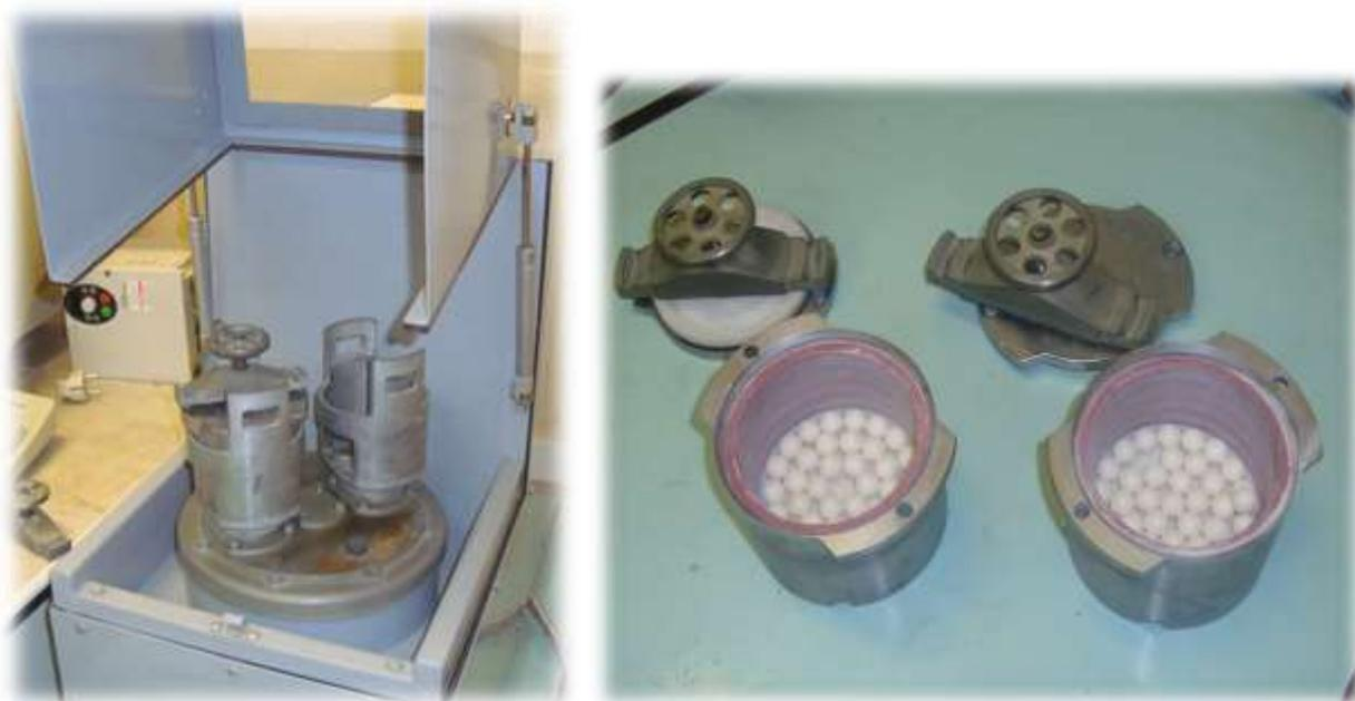
Рисунок 6 – Планетарная шаровая мельница «Активатор 2SL »
