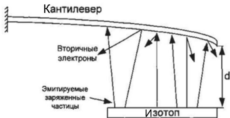
Рисунок 1.2 - Схема МЭМС – преобразователя энергии
