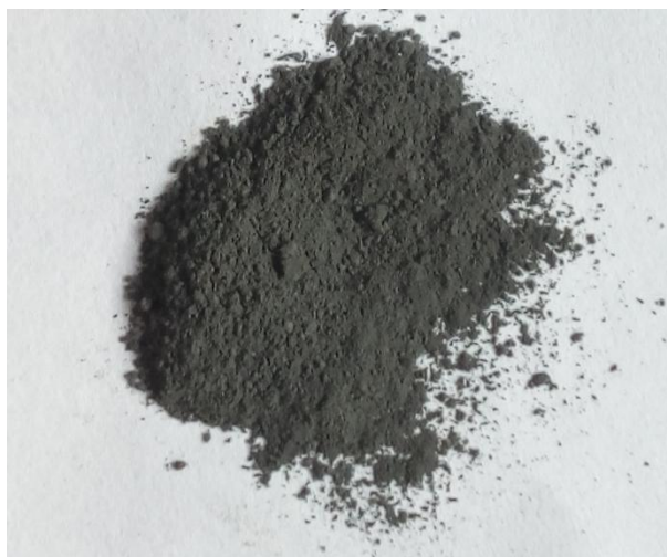
Рисунок 3.8 – Фотография полученных на плазменном стенде порошков после плазменной обработки диспергированных ВСОК
