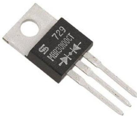
Рисунок 12 – Внешний диода Шоттки «MBR30100CT»
