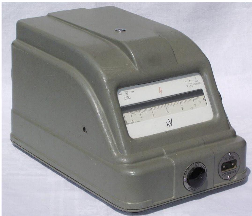
Рисунок 1. Электростатический киловольтметр С-196.
