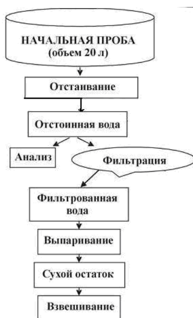
Рисунок 11 - Схема обработки и анализа водных проб
