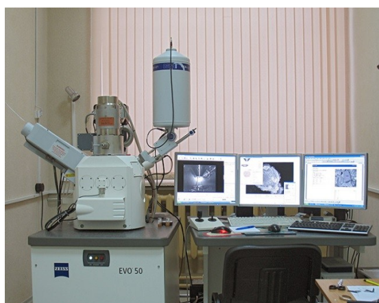
Рисунок 16 - а) растровый электронный микроскоп LEO EVO 50 с системой зондового микроанализа; б) надмолекулярная структура СВМПЭ.
