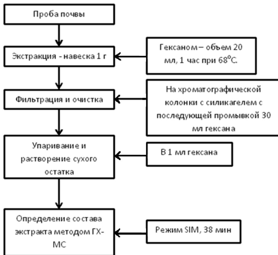
Рисунок 4 – Схема метода определения полициклических ароматических углеводородов в почвах.
