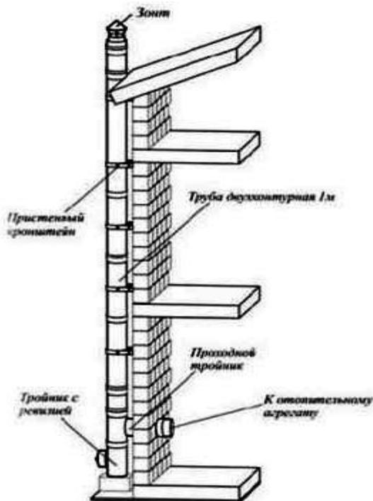
Отвод продуктов сгорания от газоиспользующих котлов в дымовой канал (дымовую трубу) (далее — канал), предусматривают от каждого котла по обособленному каналу в атмосферу.
