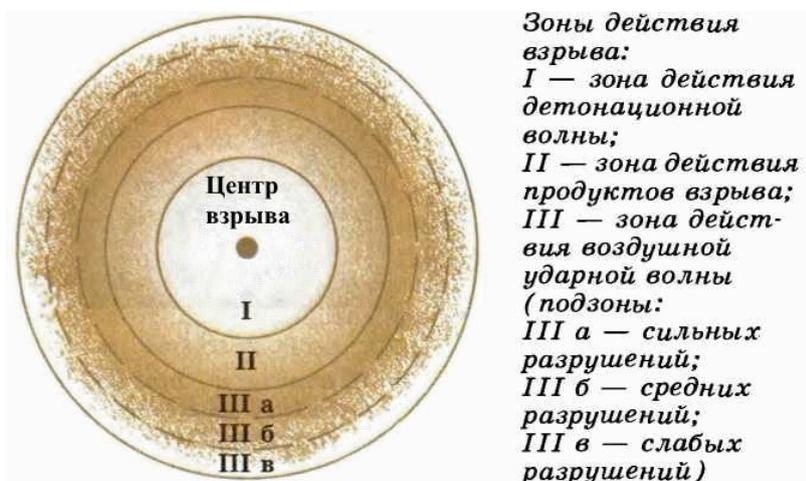
Рисунок 9 - Зоны очага взрыва газовой смеси и с распределение взрывной волны
