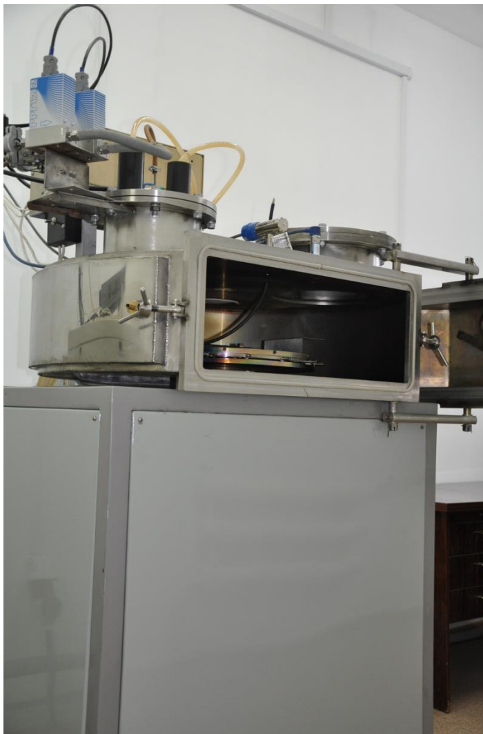
Рисунок 4 – Вакуумная установка с распылительной системой, источником ионов очистки и вращающимся подогреваемым столом с нагревом.
