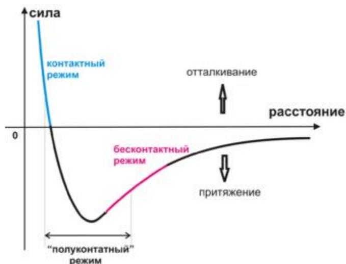
Рисунок 7 – График зависимости силы Ван-дер-Ваальса от расстояния между кантилевером и поверхностью образца
