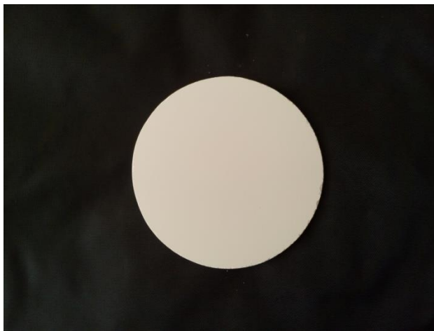
Рисунок 5 – Мишень ГАП-0,4Zn после спекания в печи при температуре 1100°C.
