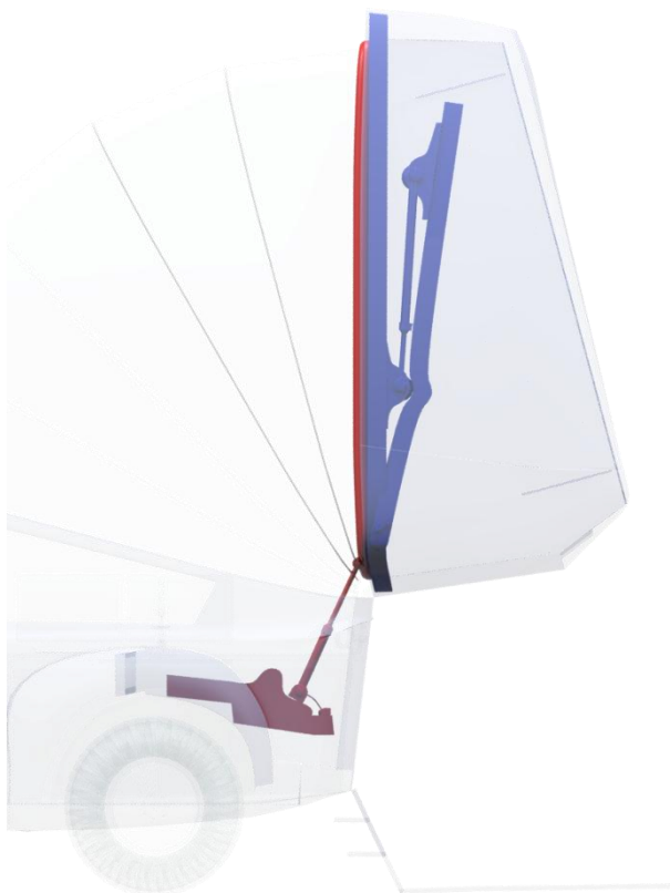
Рисунок 3.2 Откидывание крыши. Положение 1
