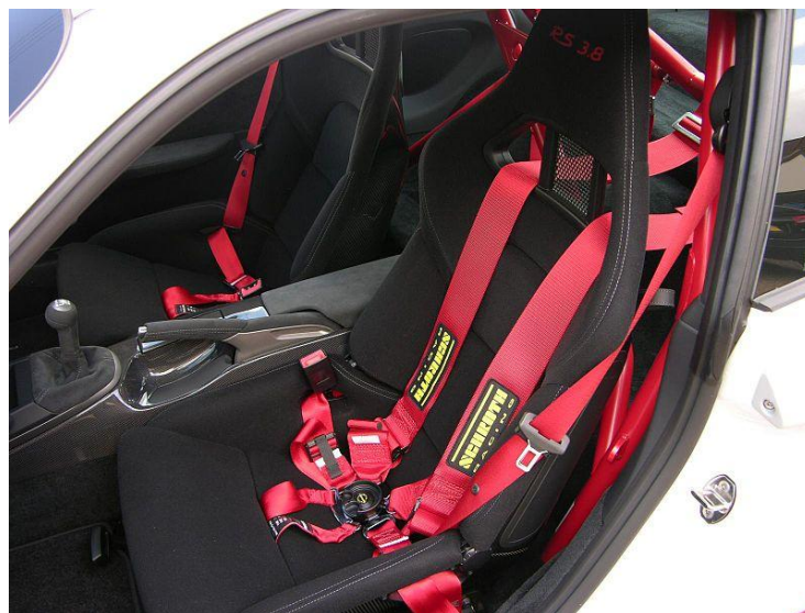
Рисунок 1.3 Сиденья ковшеобразной формы для спортивных автомобилей
