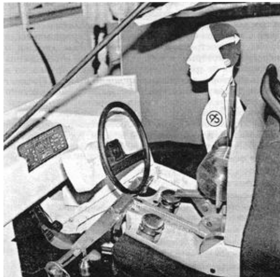
2.14 Трехмерный посадочный макет для эргономической оценки и исследований рабочего места водителя
