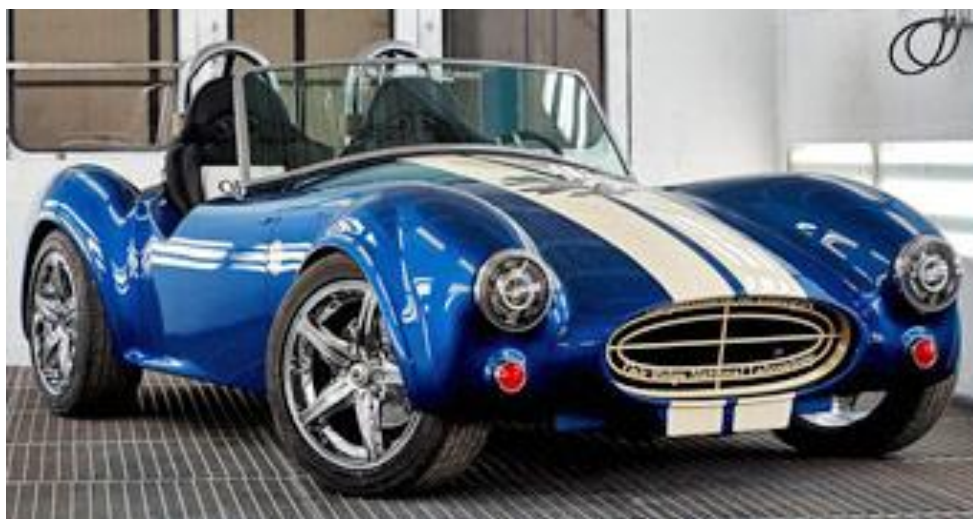
Рисунок 3.1. Автомобиль Shelby Cobra напечатанный полностью на 3Д принтере
