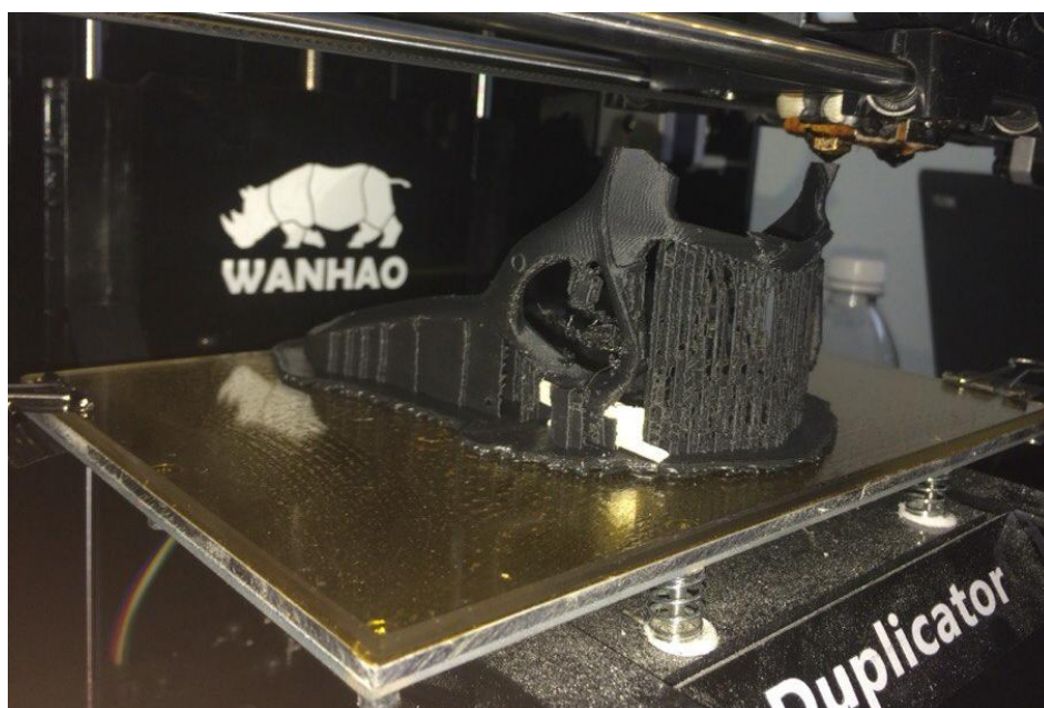
Рисунок 3.19 3D печать нижней части сиденья
