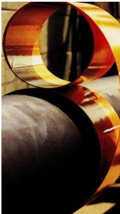
Рисунок 4.2 – Намотка рулонного стеклопластика
