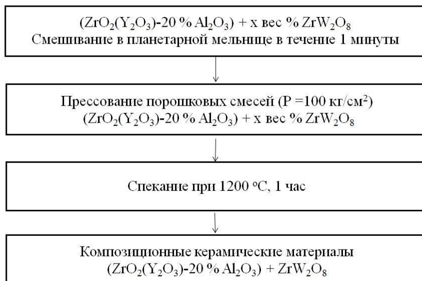
Рисунок 7 - Технологическая схема получения керамических композиционных материалов методом свободного спекания
