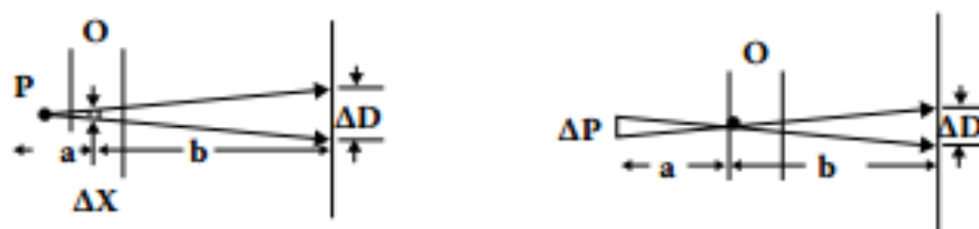
Рисунок 4 – Иллюстрация геометрического увеличения (слева) и размытия полутени (справа).
