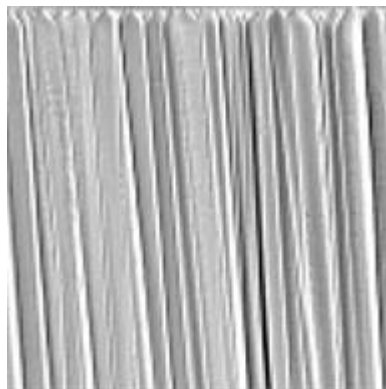
Рисунок 11 - Внутренняя структура кристаллического CsI (электронный растровый микроскоп) [63].
