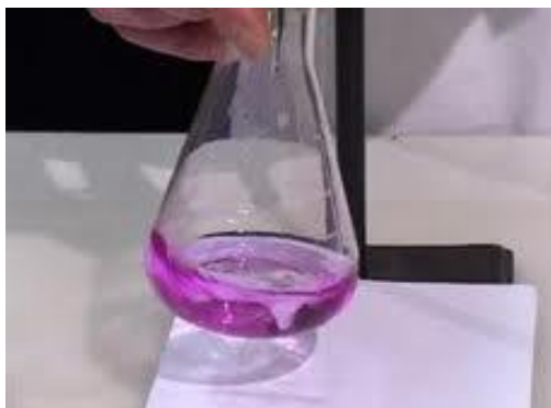
Рисунок 2.5 – титрование раствора в конической колбе
