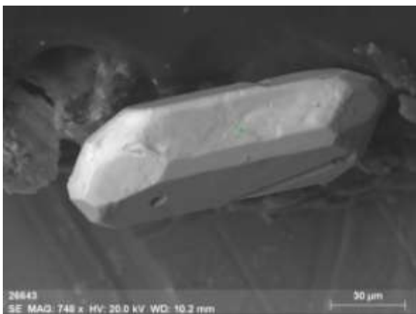
Рисунок 4.10 – Микроминеральная фаза циркония в виде циркона в ЗООЧ г. Норильска
