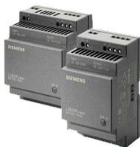
Рисунок 24 – Внешний вид контроллера LOGO! Power.
