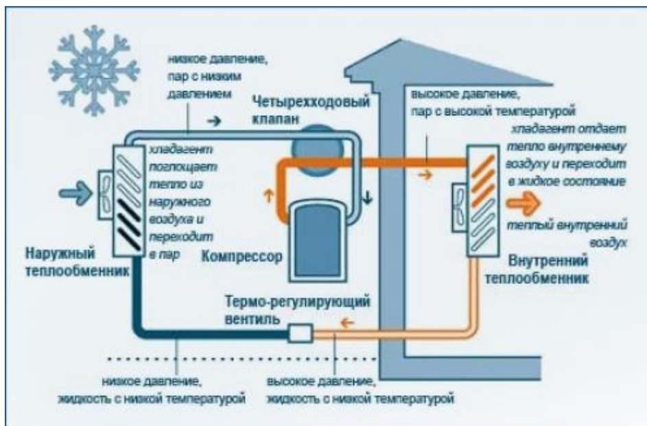
Рисунок 9 – Система отопления с воздушным тепловым насосом
