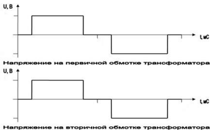
Рисунок 1.2 - Графики напряжения на трансформаторе
