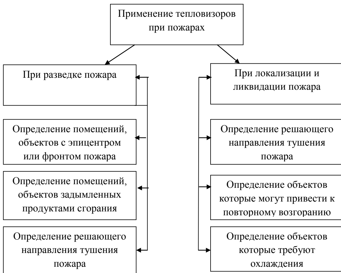
Рисунок 4 – Классификация областей применения тепловизоров пожарными подразделениями
