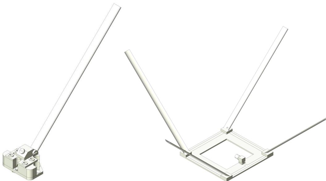
Рисунок 21 - Общий вид антенны D-диапазона
