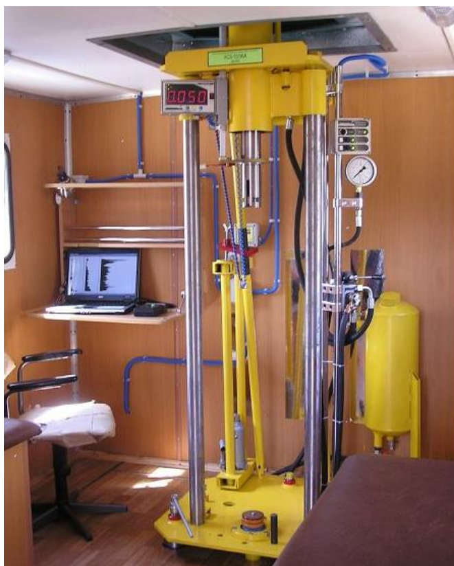
Рисунок 3.3 – Установка статического зондирования UC3 15/36A (вид внутри)
