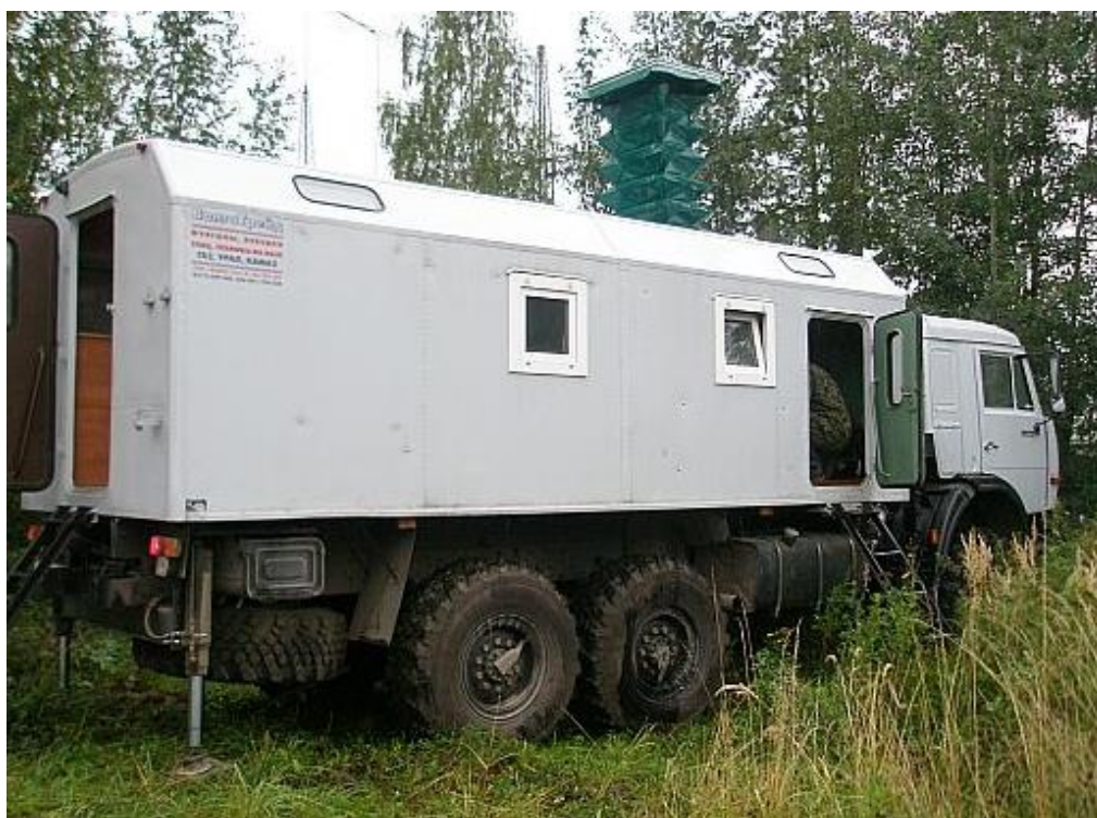
Рисунок 3.2 – Установка статического зондирования UC3 15/36A (вид с наружи)
