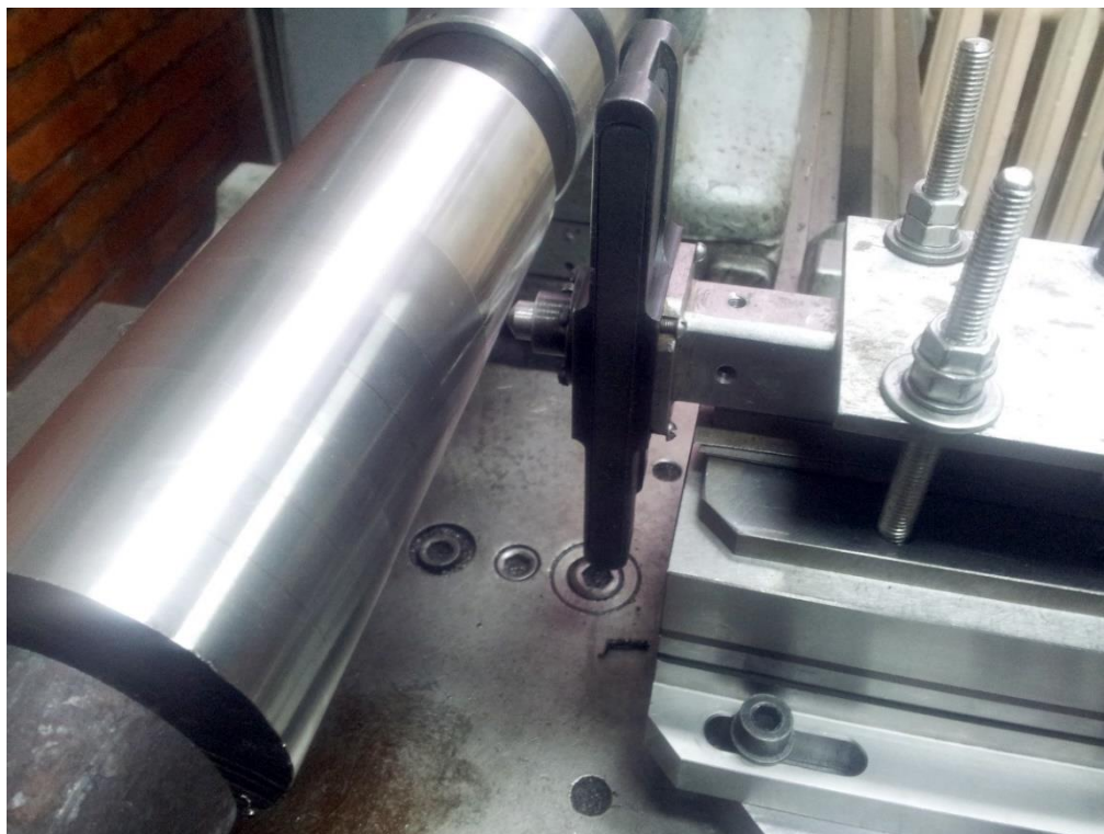
Рисунок 8. – Динамометрическая оправка расположена вертикально
