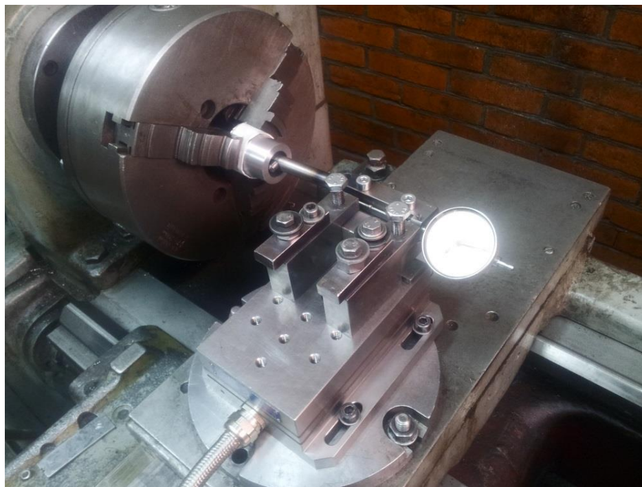
Рисунок 32 – Установленная динамометрическая оправка для внутреннего выглаживания
