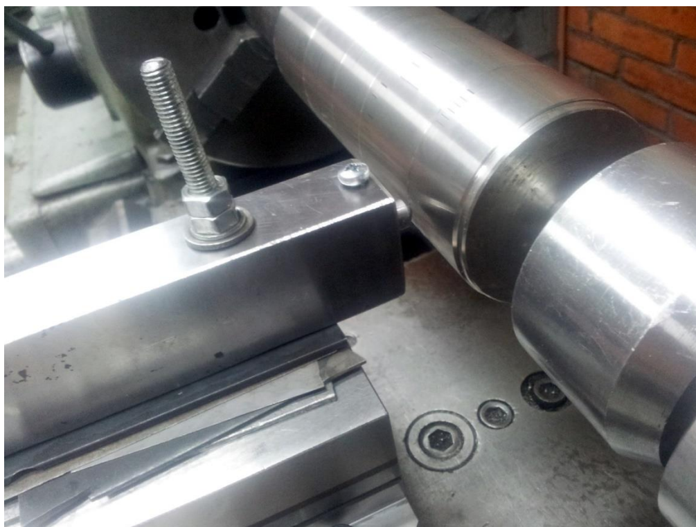
Рисунок 3 - Оправка для выглаживания жесткая
