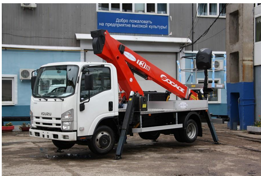
Рисунок 2.9 - Автогидроподъемник ISUZU SOCAGE T 315
